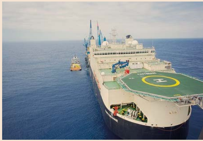
Ingegneria. La nave officina e posatubi Castorone della Saipem
